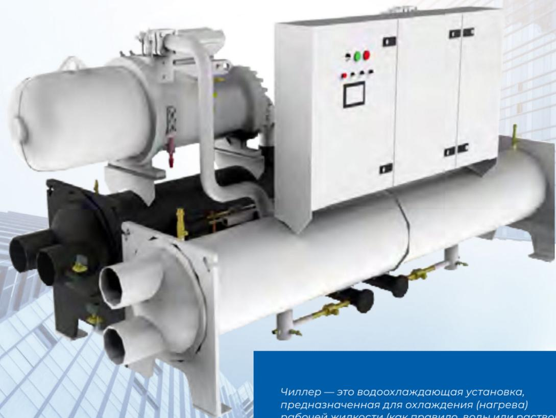
Чиллер — это водоохлаждающая установка, предназначенная для охлаждения (нагрева) рабочей жидкости (как правило, воды или растворов пропилен- либо этиленгликоля), выступающей в роли теплоносителя для системы центрального кондиционирования воздуха. Охлажденная в чиллере до требуемой температуры жидкость по трубопроводу подается в фанкойлы, приточные установки либо иные устройства для отвода тепла от промышленного оборудования.
