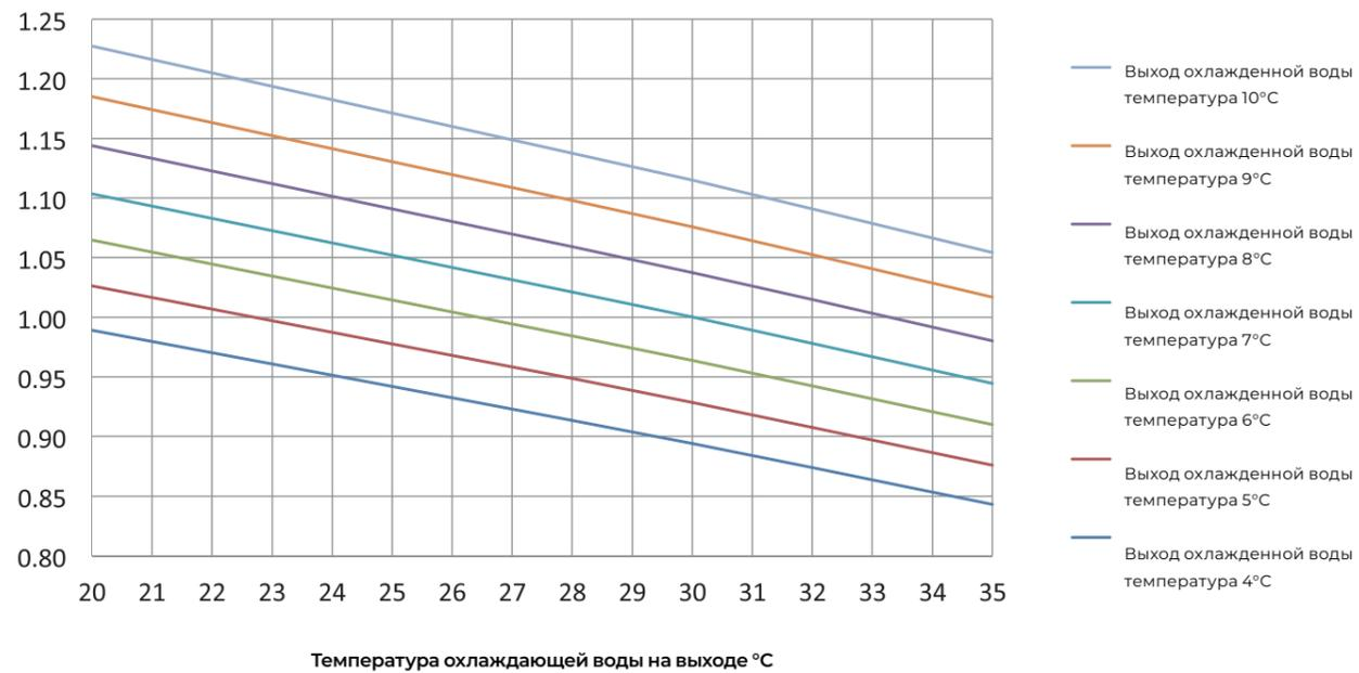
График поправочного коэффициента для потребляемой мощности
